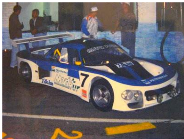
Um Fórmula 2 'carenado' nas 12 Horas. Veloz e bonito, o protótipo construído pelo piloto engenheiro da UFRGS em Santa Maria Paulo Barreto, tinha chassis e motor de Fórmula 2
